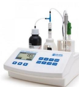
**HI84502** est un mini-titreur pour mesurer le pH et déterminer l'acidité totale par titrage à la soude.
